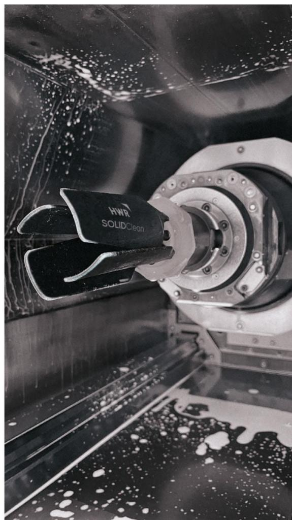
A hélice de limpeza SOLIDClean foi produzida para ajudar a remover tanto resíduos sólidos como líquidos de forma rápida e eficaz diminuindo o tempo de produção e aumentando a automação de todo o processo.
