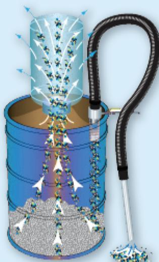
O princípio Venturi usado nas pistolas WonderGun produz vácuo por acção do ar comprimido, com baixo nível de ruído e de consumo, aumentando o volume de ar 12 vezes.
