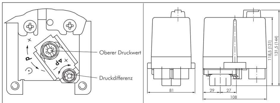
Einbau und Anschluss nur durch Fachkraft; nach Anbringung von Zubehör Funktionsüberprüfung durch Elektrofachkraft erforderlich.
