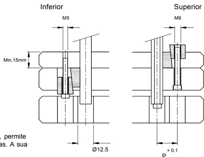
**Sistema de fixação.** Colocado nas chapas extractoras, permite a fixação correcta e garante o posicionamento das pinças. A sua força de fixação é superior a 7.500 N .
