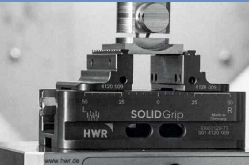
Prägespanntechnik ermöglicht maximale Haltekraft bei minimaler Einspanntiefe.
