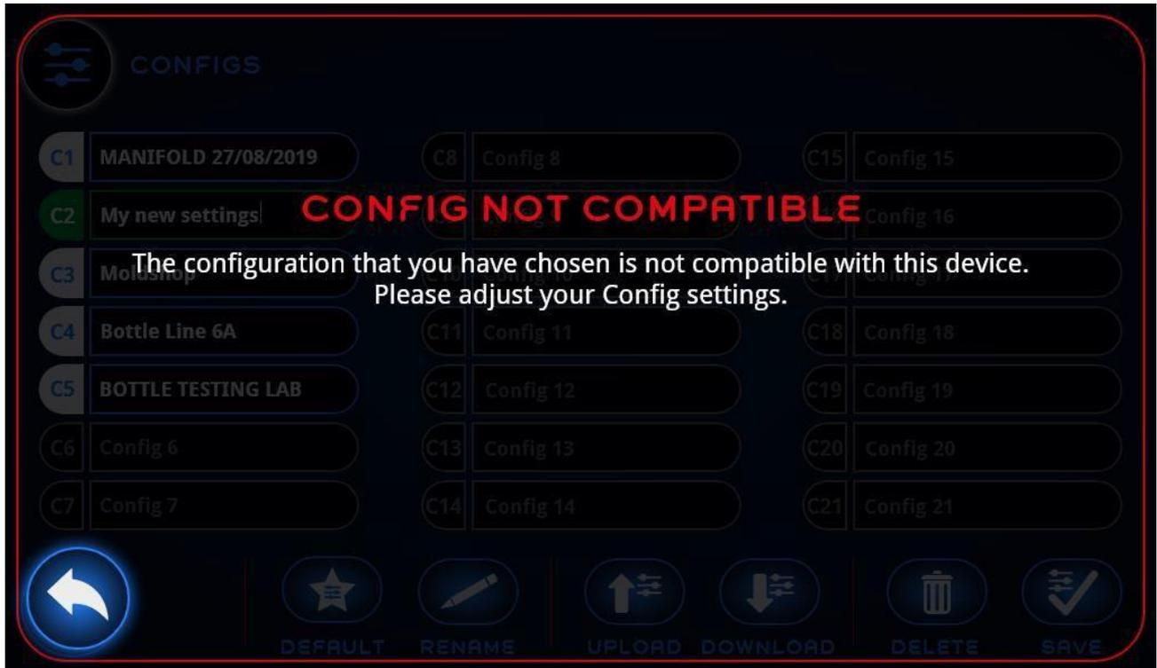
Este é o caso ou porque o número de coletores ou sensores atualmente registados não corresponde ao número de coletores ou sensores guardados na configuração. Se desejar utilizar esta configuração, é necessário ligar o coletor e os sensores apropriados antes de poder ativar a configuração.
