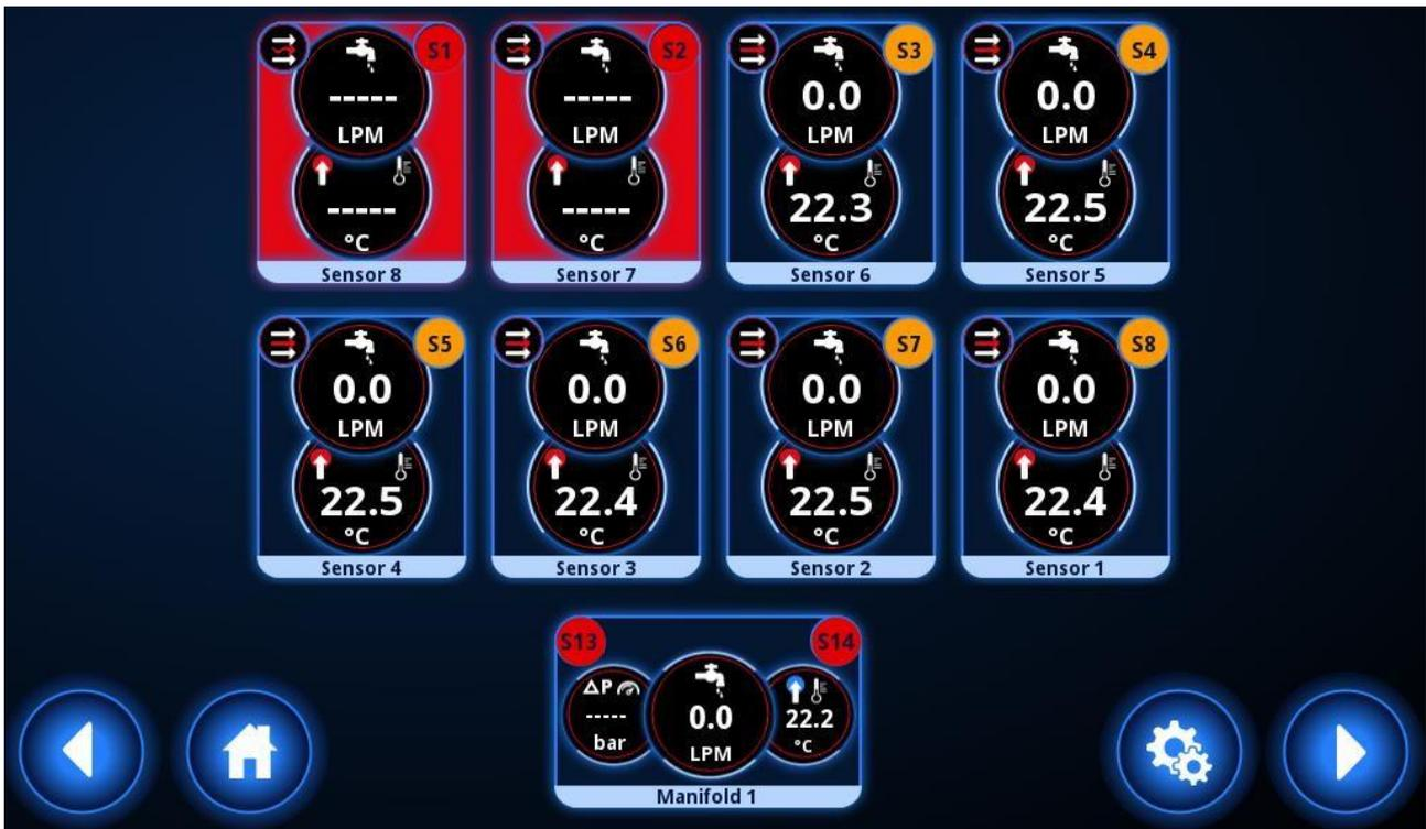
Uma coisa a ter em conta sobre as duas situações, é que os sensores irão manter os seus nomes (a barra por baixo do sensor), independentemente das definições, pelo que nomear os sensores por si próprio tornará muito mais fácil a resolução de problemas num sensor desconectado/com defeito. Especialmente se verificar após a desconexão de um sensor.
