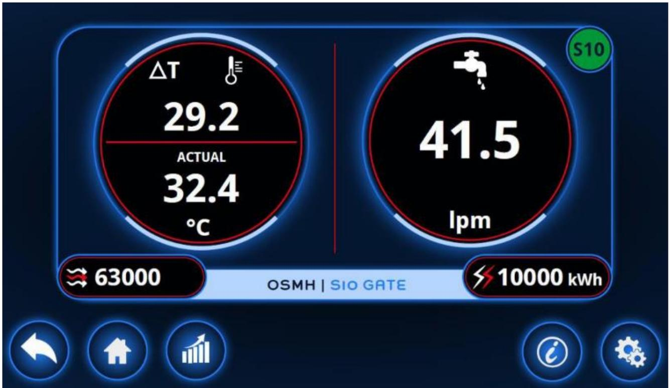
Os dados disponíveis são a diferença de temperatura da entrada e saída do canal ( $\Delta T$ ), a temperatura real na saída do canal, o fluxo medido na saída do canal, o número de Reynolds e a energia dissipada no circuito de arrefecimento calculado para o canal.
