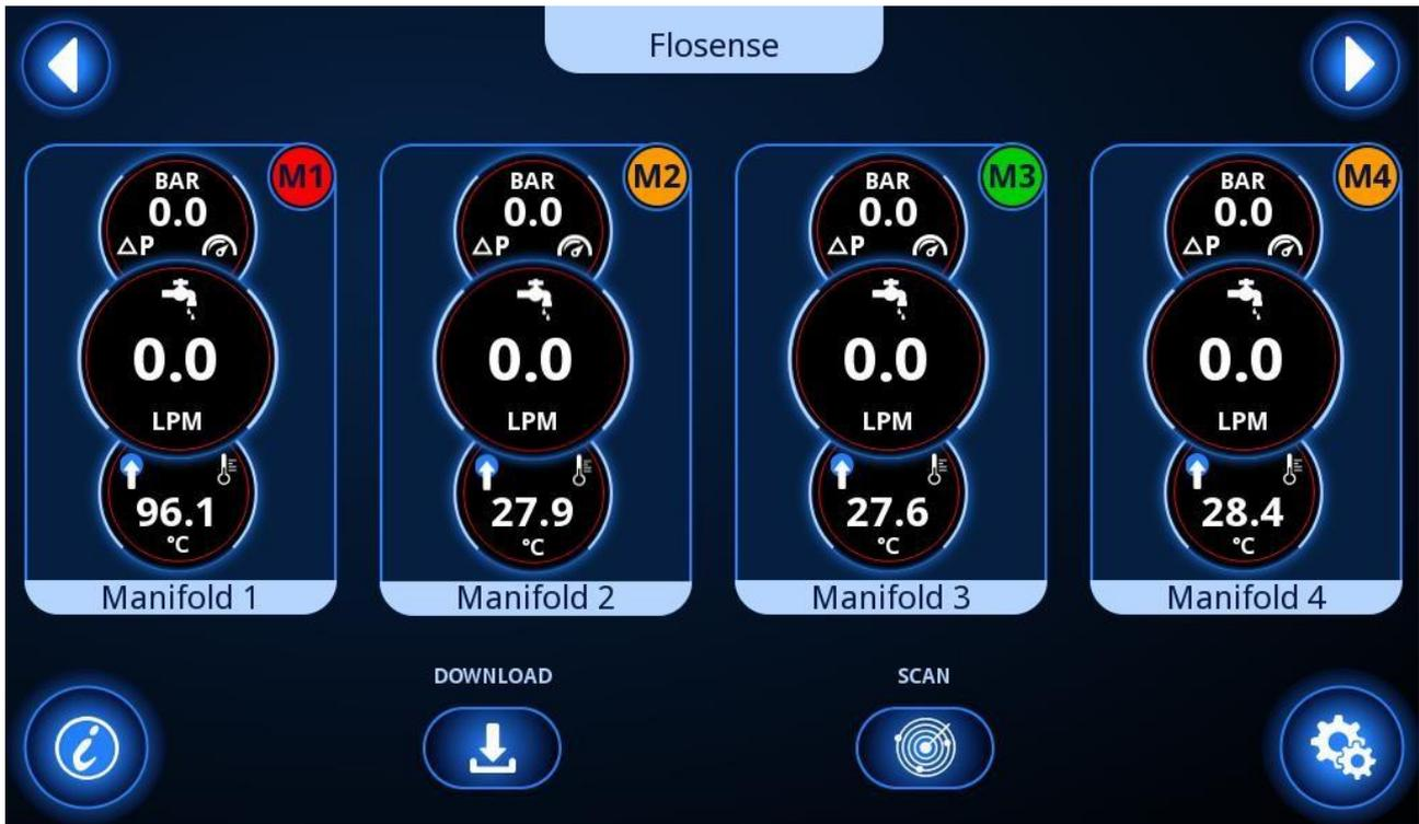
O ecrã inicial mostra o estado de funcionamento de cada um dos colectores. O estado é indicado pelo pequeno círculo colorido na parte superior direita de cada colector. Os indicadores de estado são os seguintes:
