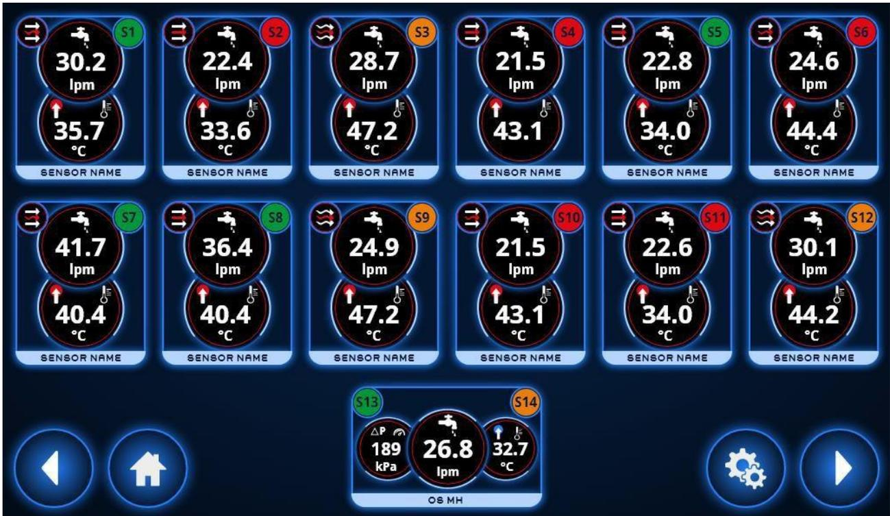
O ecrã do coletor exibe o estado de funcionamento de cada um dos sensores dentro do coletor. Exatamente como o coletor, o estado é indicado pelo pequeno círculo colorido na parte superior direita de cada sensor. Os indicadores de estado são os seguintes:
