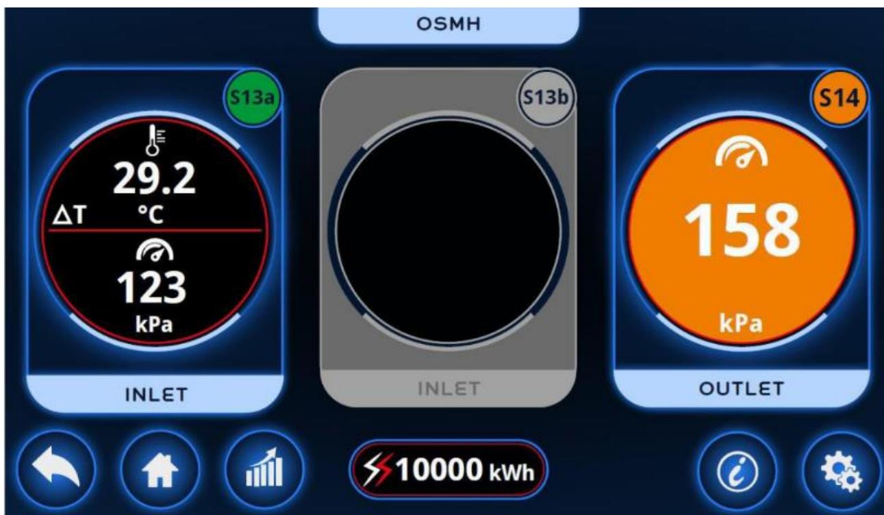
Os dados disponíveis são a diferença de temperatura da entrada e saída do coletor ( $\Delta T$ ), a pressão na entrada e saída e a energia total dissipada calculada para todos os circuitos de arrefecimento.
