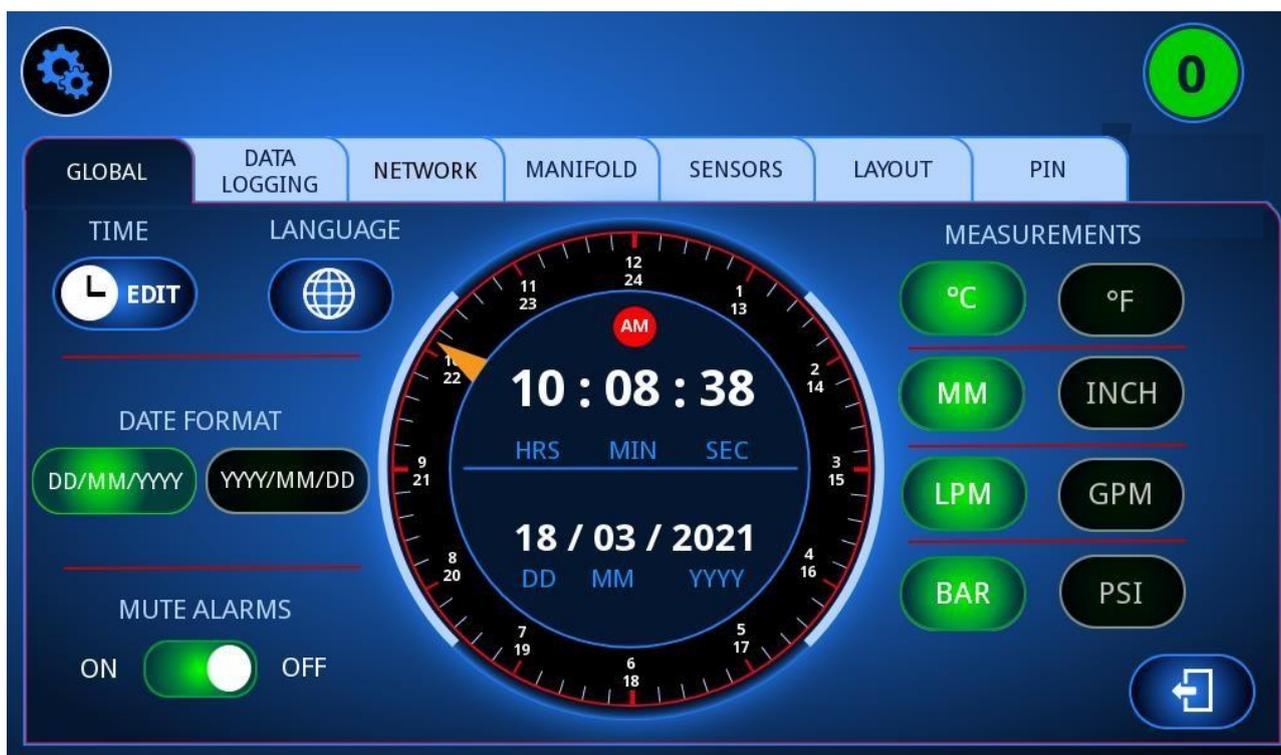
A partir do menu global, é possível alterar as definições para o ecrã e todos os coletores. À direita, é possível alterar as unidades dos dados medidos. Para a temperatura, é possível escolher entre °C e °F. Para o fluxo, é possível escolher entre litros ou gallons pr. minuto (LPM ou GPM). Para a pressão, é possível escolher entre kPa ou Bar. Para o diâmetro do canal é possível escolher entre mm e polegadas.
