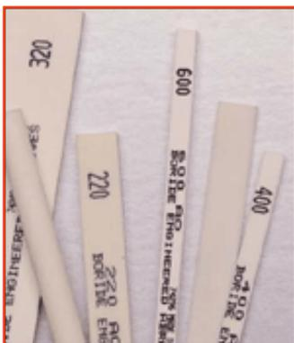
**AO:** Esta pedra tem excelentes características de corte, mantendo no entanto a forma, especialmente quando usada no polimento de cavidades detalhadas. No seu fabrico é utilizado lubrificante, pelo que não é necessária grande pré lubrificação. É recomendado o uso de lubrificante na sua utilização. Os grãos 220 e 320 são ideais para trabalhos de erosão. O grão 220 é adequado para iniciar os trabalhos em superfícies maquinadas.
